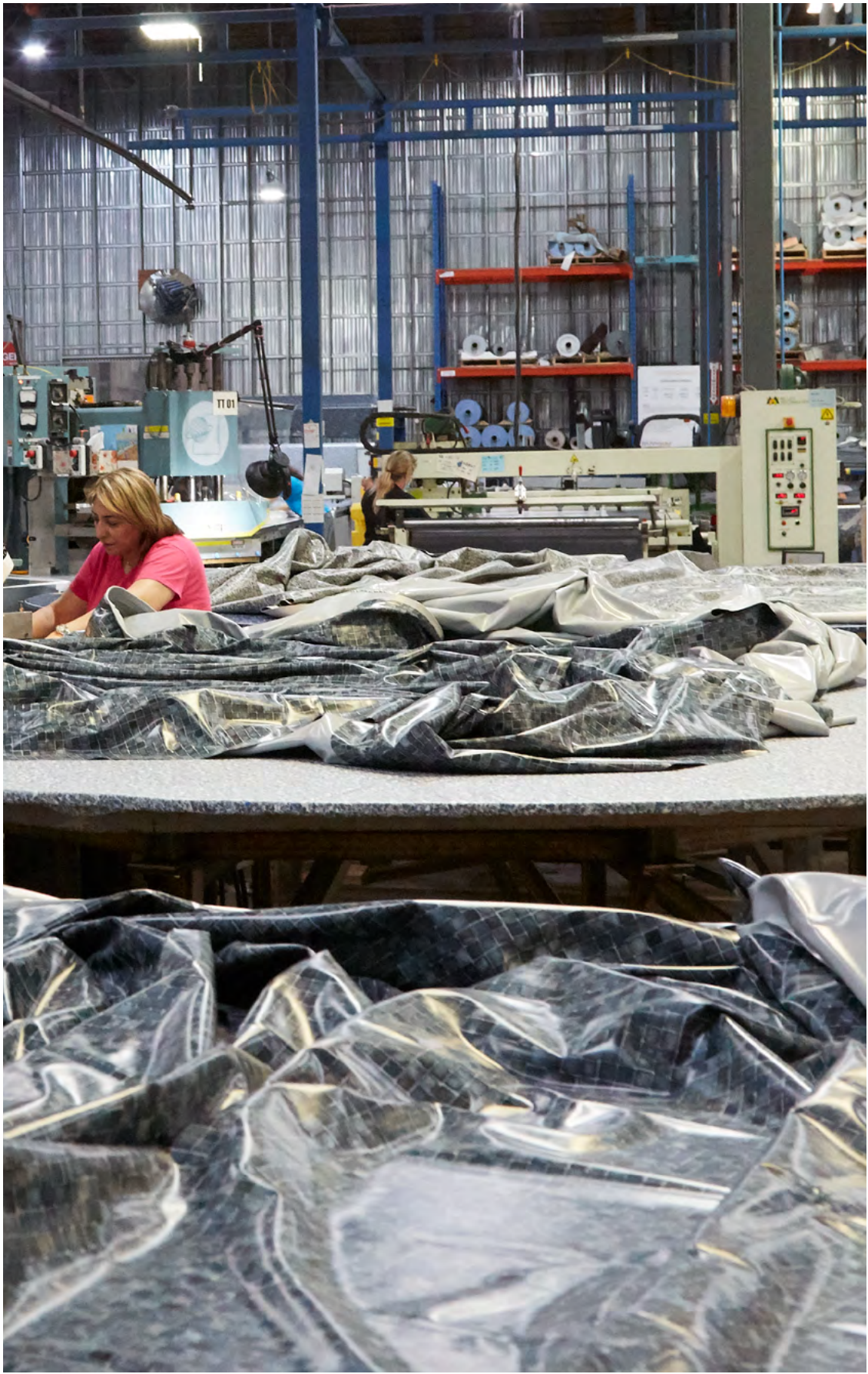
Scellage des sections de toile par chauffage à haute intensité. Sealing the liner sections with high intensity heat.
